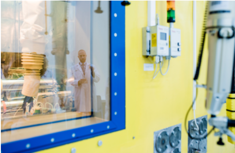
Fot. 1. „Komora gorąca”, czyli pracownia do obsługi materiałów wysokoaktywnych
