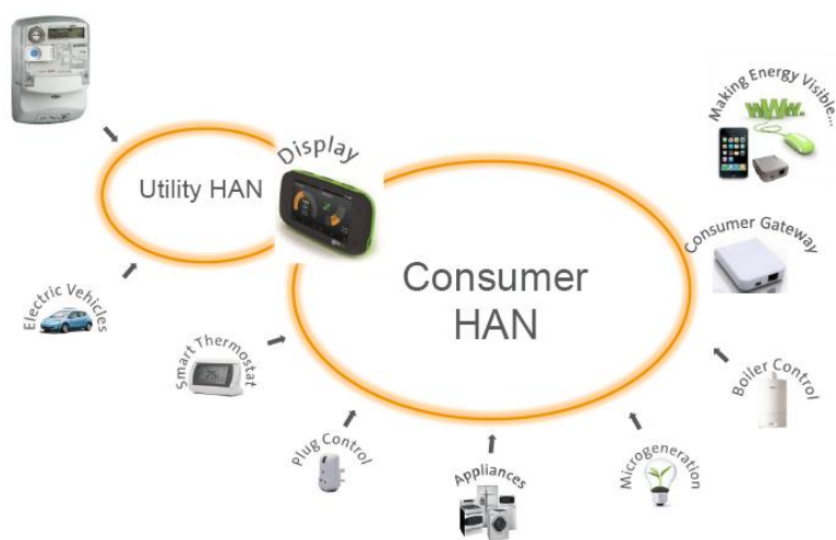
Rysunek 15. Koncepcja topologii ISD proponowana przez firmę Green Energy Options (GEO) Ltd
